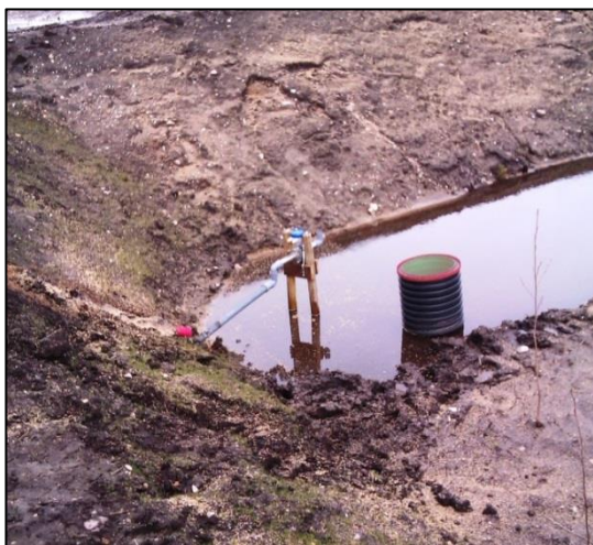
Billedet viser en af de flowmålere der registrerer hvor meget vand der løber ud i grøften der føder den aktive randzone.
